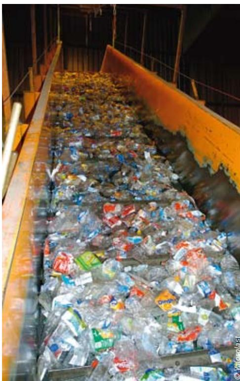
de tri. Des presses forment des cubes massifs de 280 et 750 kg chacun. Ces cubes sont rassemblés par matériaux : cartons, plastiques, ferrailles ou briques alimentaires. Une fois les balles de tri ficelées, elles sont expédiées vers les centres de recyclage. Ces balles sont vendues en tonne par le Grand Lyon aux usines de régénération.
